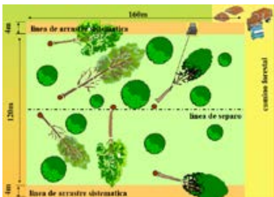
Figura 6: Plan de cosecha y arrastre con cable, la máquina se mueve en líneas sistemáticas. El volteo es direccionado para facilitar el arrastre con cable y disminuir los daños en árboles remanentes
